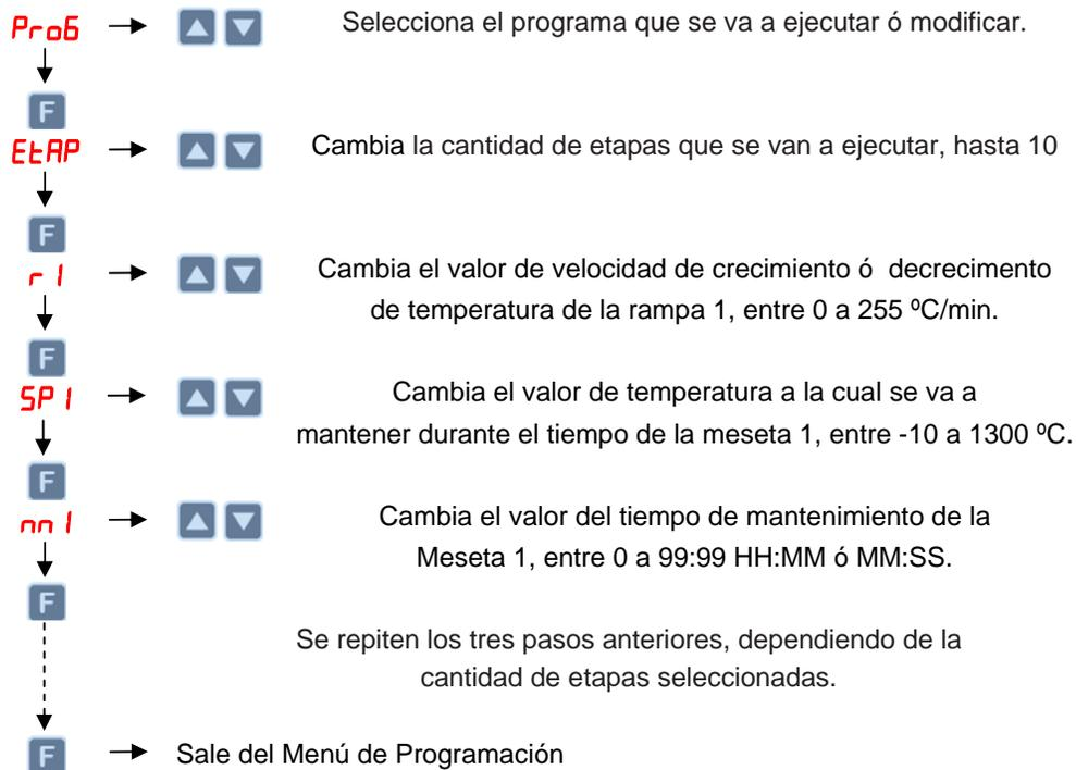
**Nota1:** Si se mantiene presionada una de las teclas ▲ ▼, luego de un momento el valor comenzara a modificarse rápidamente. Si no se presiona ninguna tecla, pasado algunos segundos sale del Modo Programación, guardando los cambios y vuelve al Modo de Control.
